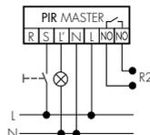
Mittels einem kurzen Tastendruck kann die Beleuchtung bei Bedarf manuell ein- bzw. ausgeschaltet werden (Achtung: Leuchtdrucktaster ohne Neutralleiteranschluss werden nicht unterstützt).
